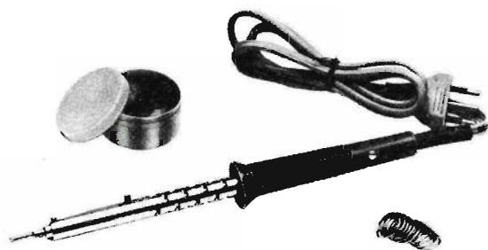
Il saldatore è un utensile necessario per la realizzazione di perfette saldature a stagno sui terminali dei semiconduttori e particolarmente indicato per i circuiti stampati. Maneggevole e leggero, assorbe la potenza di 25 W alla tensione alternata di 220 V. Nel kit contenente il saldatore sono pure inseriti 80 cm. di filo-stagno e una scatola di pasta disossidante.
