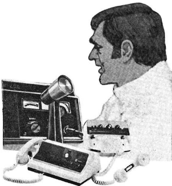
**Rispetto alla maggior parte dei microfoni per apparati CB, quello derivato da un altoparlante offre una resa di gran lunga superiore, soprattutto in sensibilità e in fedeltà. Esso può anche sostituire vantaggiosamente ogni comune microfono omnidirezionale e, in modo particolare, quelli che non lavorano in circuiti ad alta fedeltà.**
