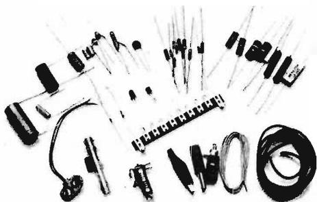
Il pacco-dono 1978 contiene un gran numero di condensatori e resistori di tipi e valori diversi, alcuni semiconduttori e una certa quantità di materiale vario (filo-stagno, filo per collegamenti, lampada e porta-lampada, presa polarizzata, spinotto, pinza a bocca di coccodrillo, boccola, morsettiera, diodo Led, ecc.).
